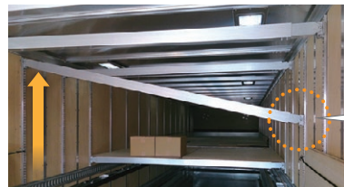
上方向へは持ち上げるだけ! ※荷物が乗っていない状況で操作してください。
